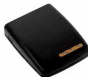
Le système SmartLiving est programmable et contrôlable à distance à travers la ligne PSTN à travers le SmartModem100. Le SmartModem100 doit être utilisé par l'installateur avec un PC sur lequel tourne le logiciel INIM SmartLeague. Le modem s'interface avec le PC à travers une porte USB. L'alimentation est prélevée directement par la porte USB du PC en évitant ainsi l'utilisation d'alimentation externe. Ses dimensions réduites le rendent facile à placer dans toutes les situations.
