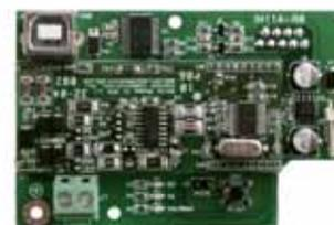
SmartModem200 est une carte modem qui permet d'effectuer la programmation et le contrôle des centrales SmartLiving (télé-assistance) en utilisant des protocoles modem téléphoniques "standard".
